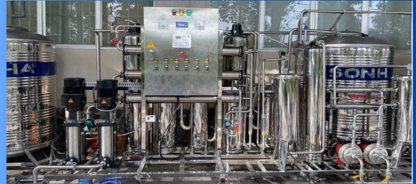
HỆ THỐNG LỌC NƯỚC SIÊU TINH KHIẾT RO-EDI SẢN XUẤT VI MẠCH
