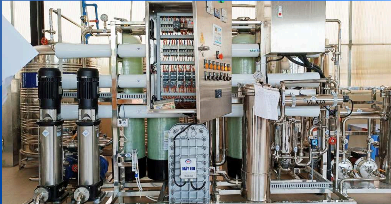
HỆ THỐNG RO- EDI 500 LÍT GIỜ SẢN XUẤT DƯỢC PHẨM
